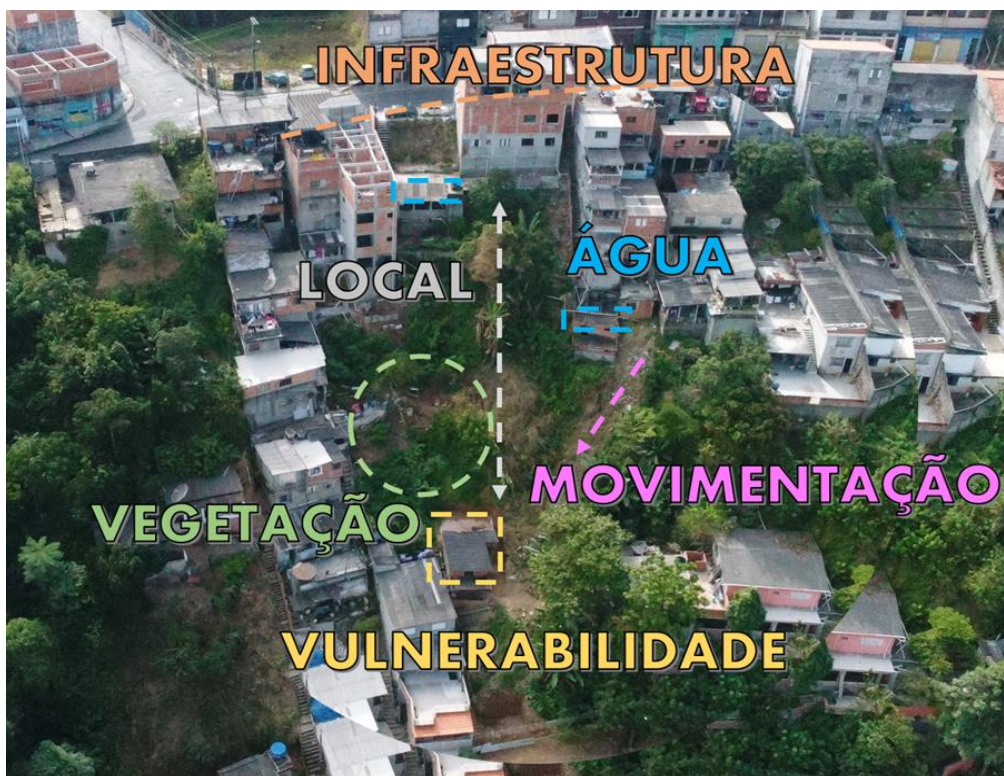
Figura 9. Principais aspectos a observar na Imagem oblíqua obtida por voo de drone. Fonte: LabGRis, 2020.
