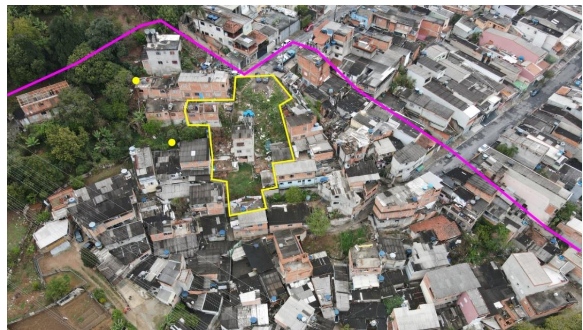
Foto oblíqua de São Bernardo do Campo, com pré-setorização e pontos críticos observados em escritório que permitem organizar roteiro de campo e otimizar a investigação em escala de detalhe. Fonte: LabGRis, 2020.
