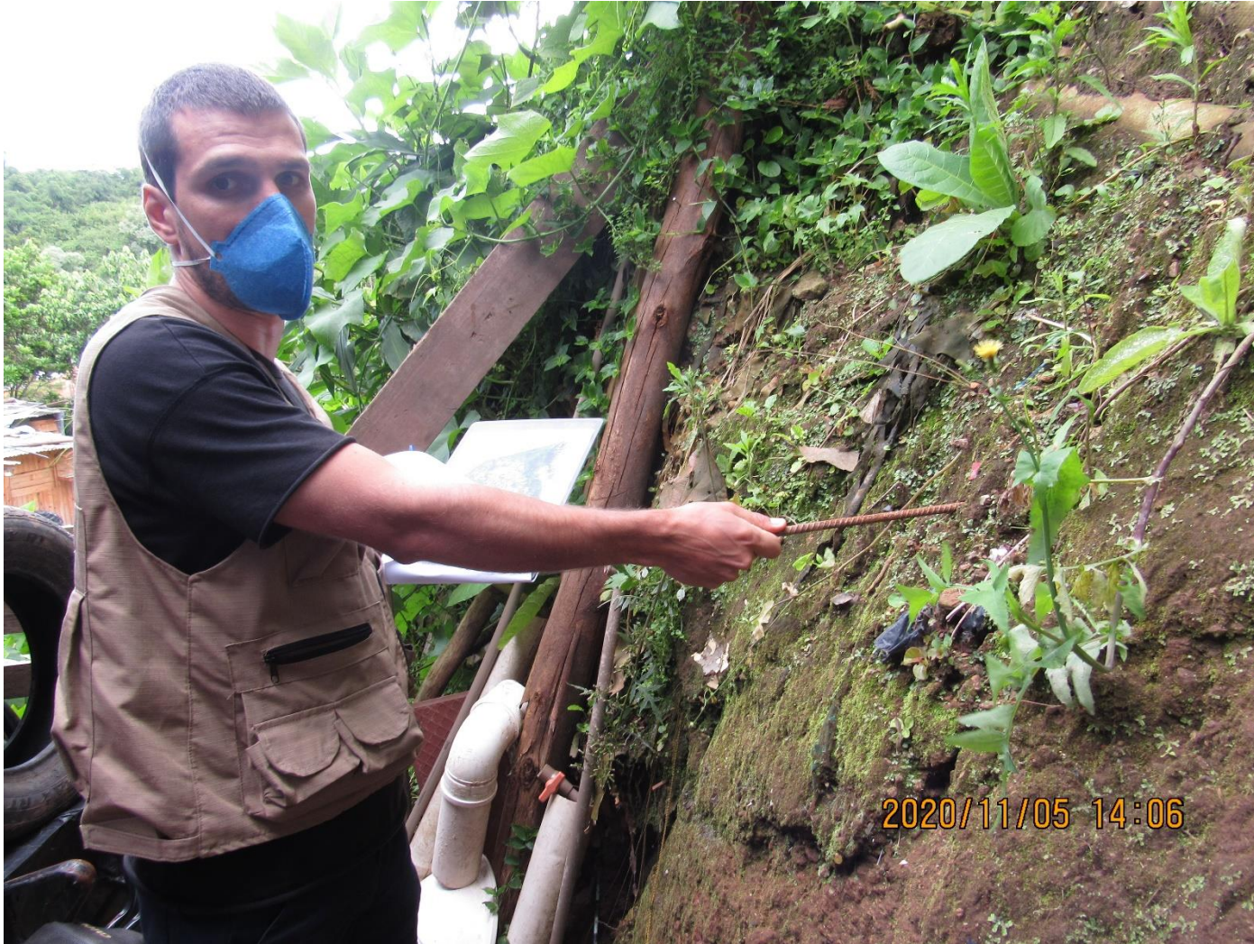
FC-SBC35_S1-02 – Integrante da equipe do LabGRis efetuando teste rápido de resistência do solo/rocha à penetração.
