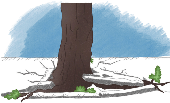
Figura 12: Calçadas quebradas pelas raízes.
