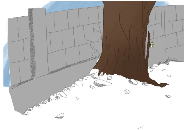
Figura 13: Muros e estruturas danificados pelas árvores.
